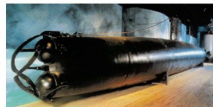
HA-19 văzut din prova, cu capetele celor două torpile de 456 mm, dispuse vertical. Lansat în 1938, avea un deplasament de 46 tone în imersiune, dimensiunile principale fiind: 24 x 1,8 x 1,8 m. Propulsat de un motor electric de 600 CP, avea o viteză de 23 de noduri la suprafață și 19 în imersiune. Raza de acțiune în imersiune, cu viteza de 2 noduri, era de 100 de mile marine.
